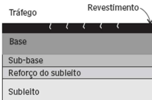
Figura 1 - Seção típica de pavimento asfáltico
