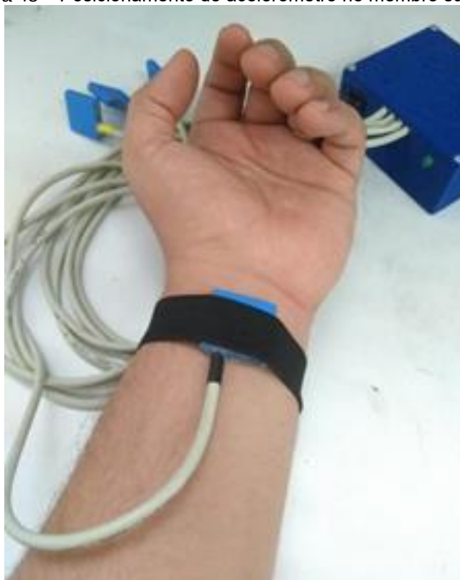
Figura 48 – Posicionamento de acelerômetro no membro superior
