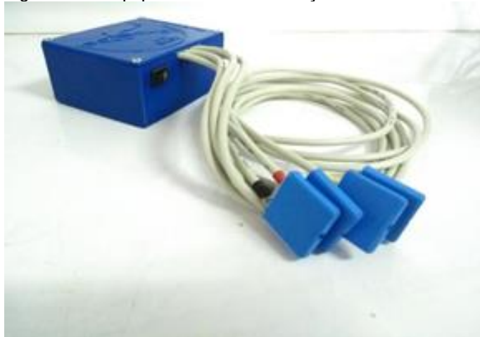
Figura 47 – Equipamento com utilização de acelerômetros
