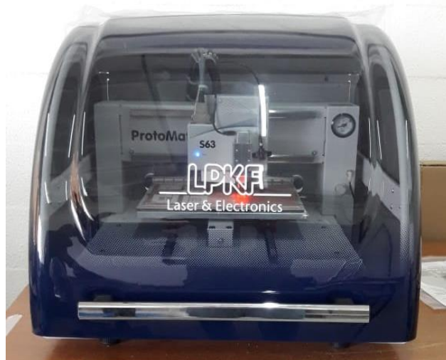
Figura 66 - Máquina de prototipagem utilizada na fabricação dos dispositivos.
