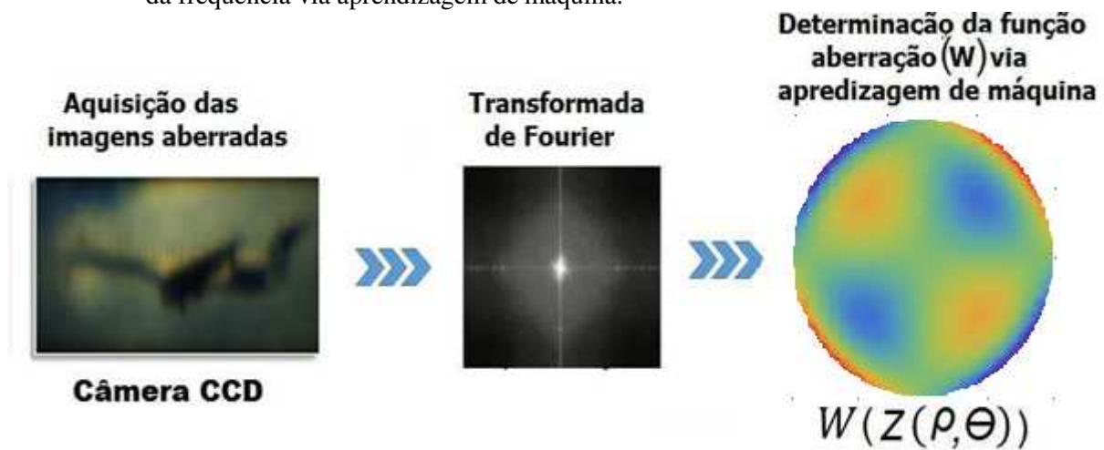
Figura 7 — Sequência para a identificação das aberrações ópticas em uma imagem aberrada no domínio da frequência via aprendizagem de máquina.
