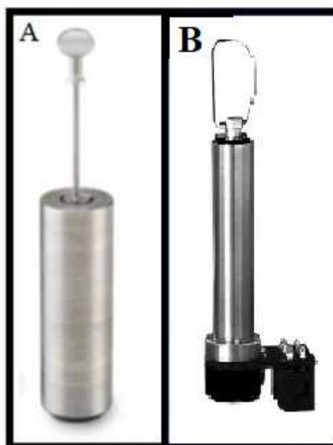
Figura 54 — Scanners utilizados na varredura de alta frequência(12kHz A ) e de baixa frequência (1kHz) em B )
