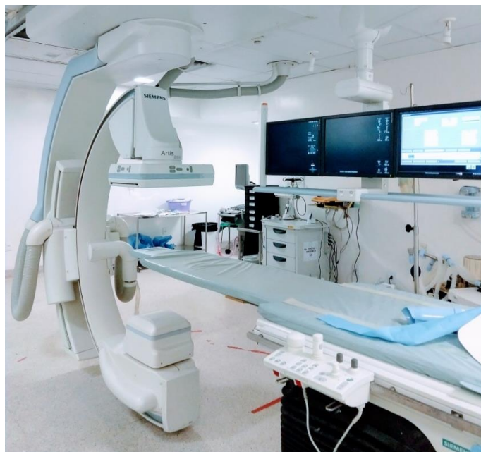
Figura 16 - Angiógrafo Siemens Artis Zee ceiling, empregado nos procedimentos de neurorradiologia intervencionista.
