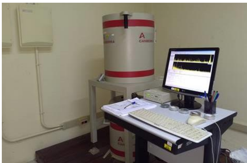
Figura 13 – Sistema de EGAR com detector HPGe utilizado para a determinação de radionuclídeos naturais.
