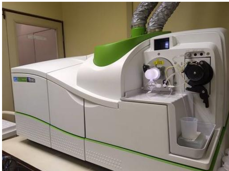
Figura 17 - Equipamento NexION 300, PerkinElmerSCIEX, a ser empregado para determinação de Cd e Sb em solos e folhas por ICP-MS.
