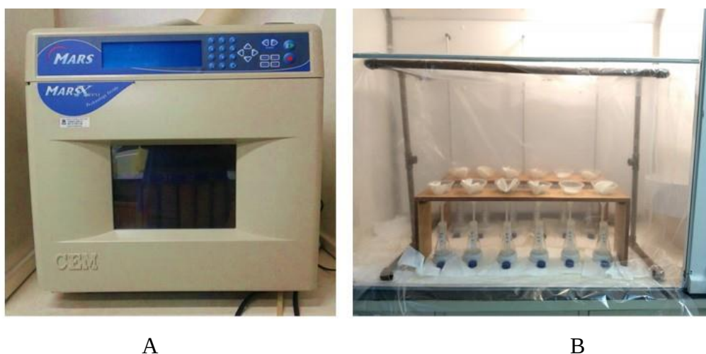
Figura 14 – Tratamento químico de amostras A. Forno digestor MARSXpress da CEM. B. Filtração de amostra nos tubos Falcon.
