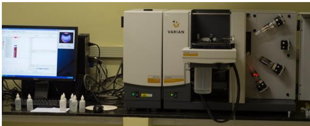
Figura 16 - Espectrofotômetro de absorção atômica VARIAN AA240Z (Zeeman) com forno de grafite GTA 120.
