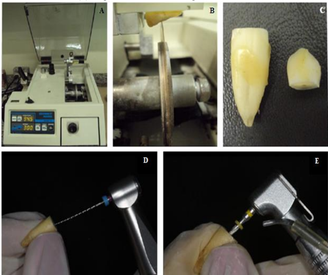
Figura 1. Preparo da amostra. (A) Cortadeira metalográfica; (B) Secção dos dentes na JAC com disco diamantado; (C) Segmentos radicular e coronário após secção; (D) Instrumentação do canal radicular e (F) Preparo do canal radicular para receber os materiais intracanal.
