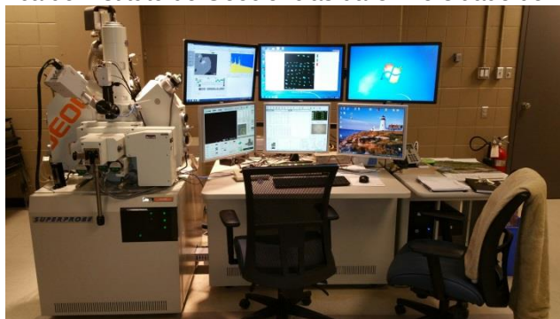
Figura 3 - Microsonda Eletrônica (Microprobe JEOL JXA-8230) do Laboratório de Microsonda Eletrônica do Instituto de Geociências da Universidade de Brasília.
