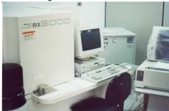
Figura 1 - Espectrometro de Fluorescência de Raios-X (Rigaku RIX 3000) do NEG-LABISE do Departamento de Geologia da Universidade Federal de Pernambuco.
