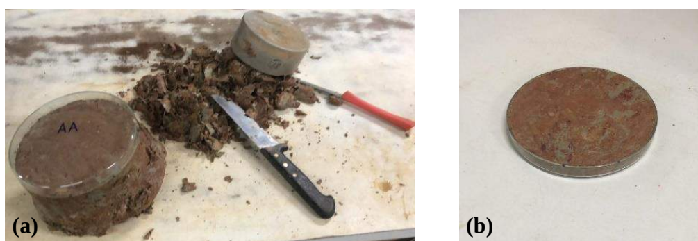
Figura 74 – Detalhe da moldagem do ensaio de fissuras L3: (a) Moldagem do solo indeformado na placa petri; (b) Detalhe do final da moldagem do solo indeformado na placa petri
