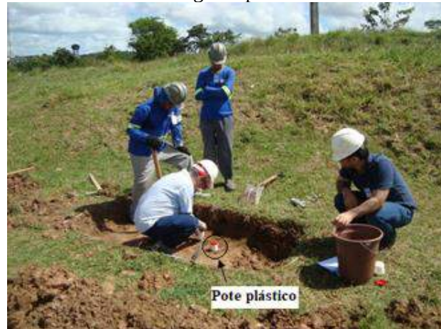
Figura 13 – Coleta das amostras ao longo da profundidade para determinação da variação da sucção ao longo do perfil
