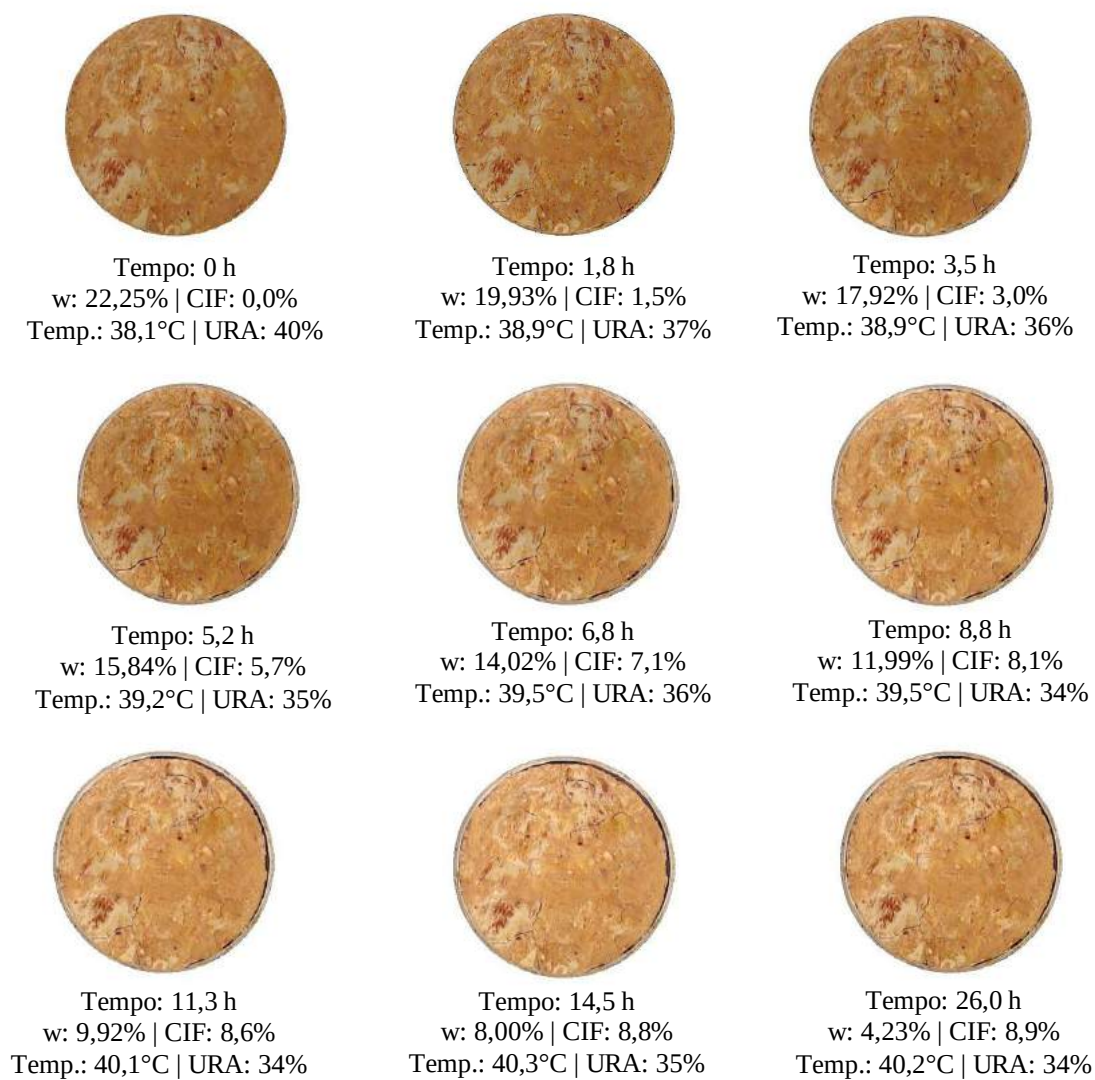
Figura 97 – Sequência da evolução das fissuras no Ensaio L3
