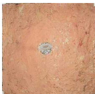
Figura 173 – Sequência de imagens do corpo de prova 3 submetido a três ciclos de molhagem-secagem
