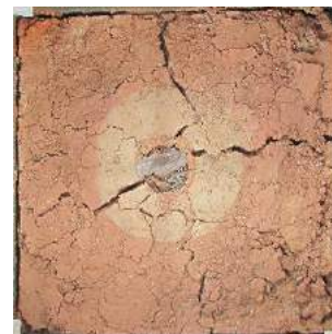
Figura 173 – Sequência de imagens do corpo de prova 3 submetido a três ciclos de molhagem-secagem
