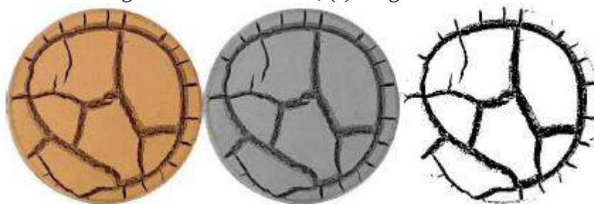
Figura 62 – Estágios de processamento de uma imagem digital: (a) Imagem original colorida; (b) Imagem em escala de cinza; (c) Imagem binarizada
