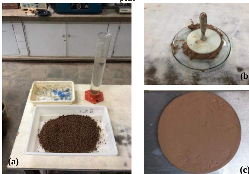
Figura 72 – Moldagem dos ensaios de fissuras L1 e L2: (a) Início da moldagem do solo na placa petri; (b) Moldagem do solo na placa petri com o uso do moldador; (c) Detalhe do solo moldado na placa petri
