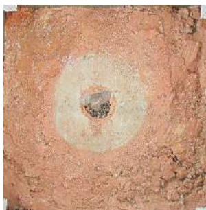
Figura 173 – Sequência de imagens do corpo de prova 3 submetido a três ciclos de molhagem-secagem
