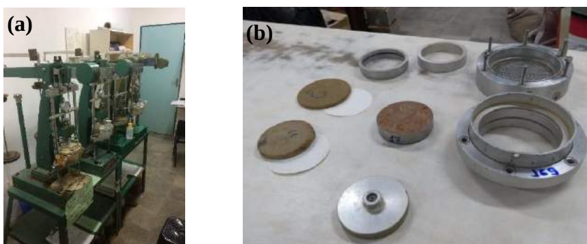
Figura 20 – Ensaio de compressão edométrica convencional: (a) Detalhe da prensa de compressão edométrica com o ensaio em andamento; (b) Montagem da célula de compressão edométrica e detalhe da aparelhagem utilizada
