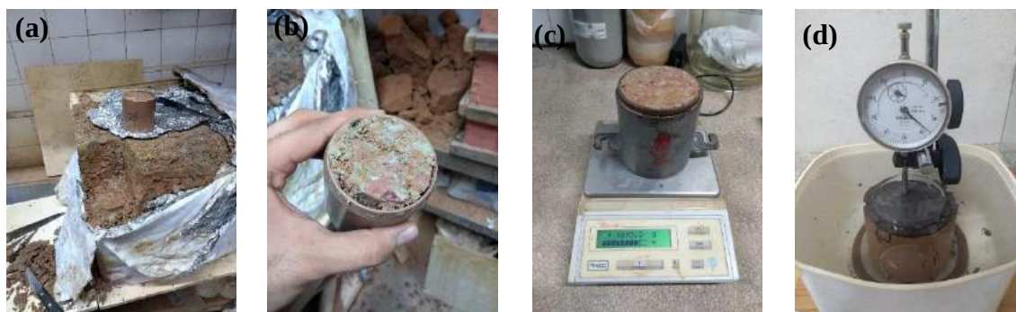
Figura 18 – Moldagem da amostra para ensaios no tomógrafo computadorizado: (a) Moldagem do tubo de PVC no bloco indeformado; (b) Amostra moldada no tubo de PVC e verificação de vazios no tubo; (c) Compactação do solo no cilindro de compactação com aplicação de energia normal, umidade ótima e densidade seca máxima; (d) Processo de umedecimento da amostra e medição da expansão com o uso de um extensômetro
