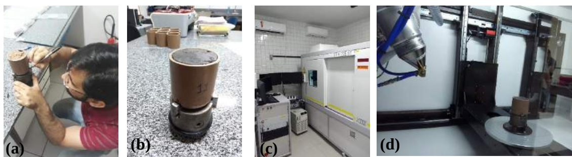
Figura 19 - Início do ensaio no tomógrafo computadorizado: (a) Fixação da amostra no suporte do tomógrafo; (b) Amostra fixada no suporte do tomógrafo; (c) Tomógrafo de raios-x, modelo NIXON XT H 225 ST (d) Amostra posicionada no interior do tomógrafo
