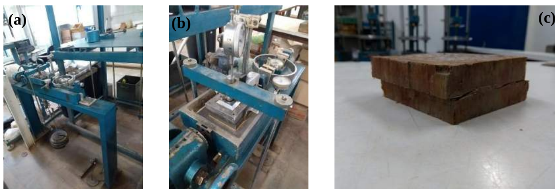
Figura 22 – Ensaio de cisalhamento direto: (a) Aplicação da tensão normal na amostra; (b) Cisalhamento do corpo de prova; (c) Detalhe do corpo de prova após cisalhamento
