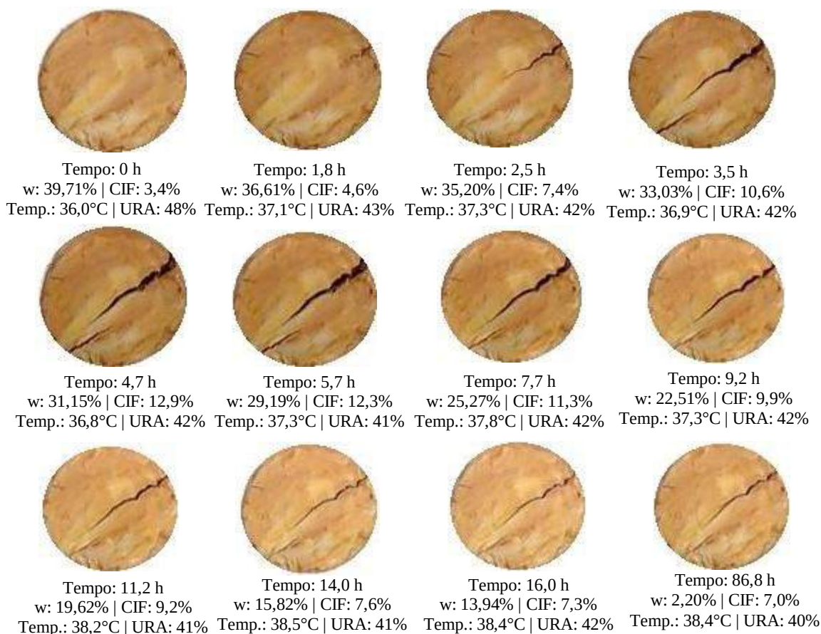
Figura 103 – Sequência da evolução das fissuras no Ensaio L5
