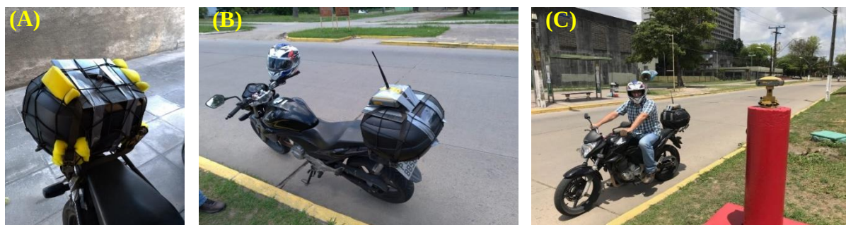
Figura 29 – Estrutura captação dados GPS 10hz a) Estrutura de fixação do GPS b) Fixação do GPS na estrutura c) GPS fixo para correção de posição e GPS móvel
