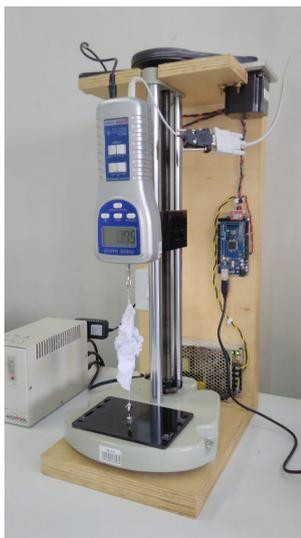
Figura 15 – Foto da máquina automática usada para esticar a folha amassada.
