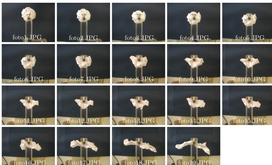
Figura 44 – Exemplo de uma das dez amostras da expansão transversal da folha amassada. Cada fotografia registra a folha de papel numa posição  $\Delta x$  diferente.
