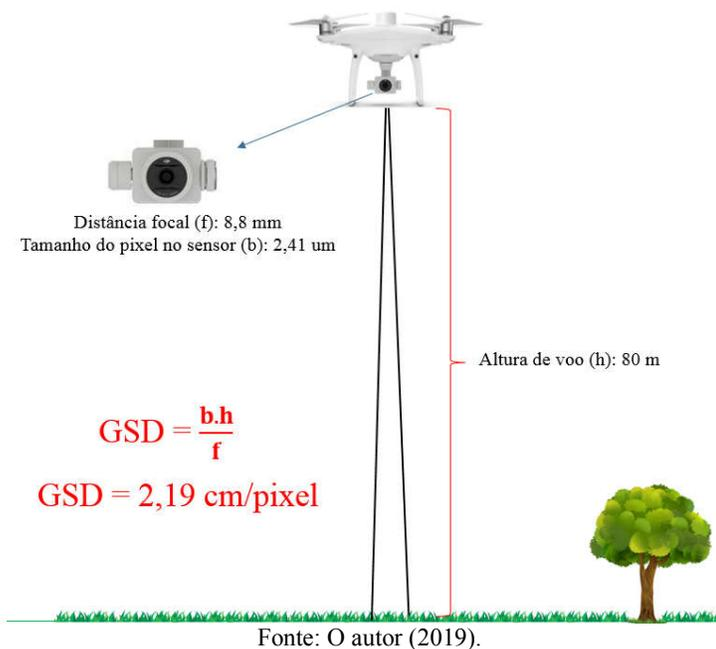
A altura de voo dos levantamentos aéreos foi de 80 metros, entretanto o ponto de decolagem foi a partir de uma das bancadas da pedreira, portanto a altura variou aproximadamente entre 80 a 110 metros devido a topográfica da cava. A figura 19 ilustra as variações de altura da aeronave em relação ao terreno dependendo do ponto de decolagem.
