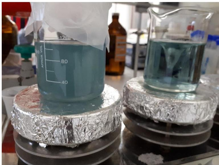
FIGURA 39- SÍNTESE DE NPANI@NZIF-8 IN SITU EM 5ML DE SOLUÇÃO NPANI E 95ML DE METANOL. NO BÉQUER À DIREITA TEMOS O INÍCIO DA SÍNTESE, NO BÉQUER À ESQUERDA TEMOS A SÍNTESE DE NZIF-8 EVIDENCIADA PELA TURBIDEZ DA SOLUÇÃO APÓS 10MIN DE AGITAÇÃO.
