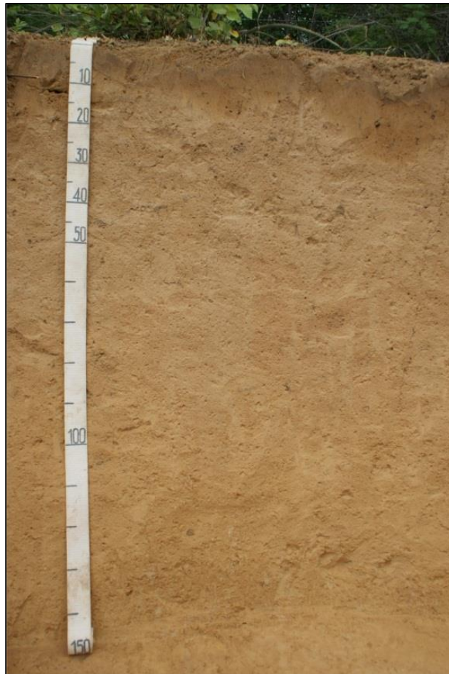
Figura 14 - Perfil de Latossolo amarelo, apresentando camadas mais homogêneas.
