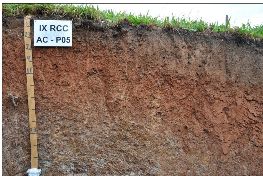
Figura 13 - Perfil de Argissolo vermelho, onde é possível observar camadas bem diferenciadas.
