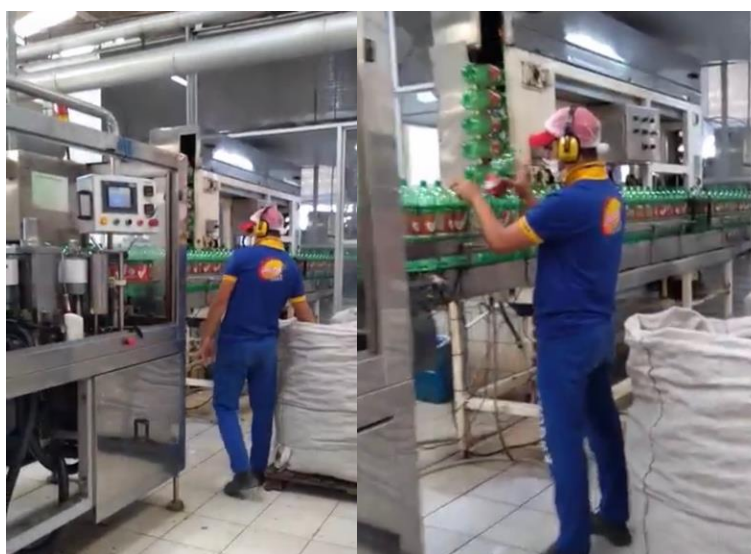
Figura 21 - Substituição das garrafas com falha de produção
