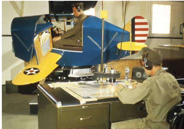
Figura 17: Simulação de voo no C-3 Link Trainer, US Army Air Forces, 1940s.
