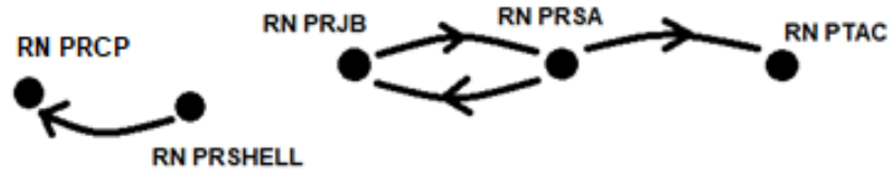
Figura 21 - Procedimento do nivelamento geométrico referente ao dia 30/07/2018.
