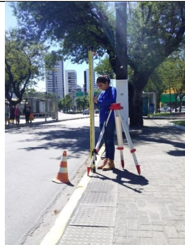
Figura 22c: Mira (Régua) no ponto RN PRCP. Foto: 16 de julho de 2018.
