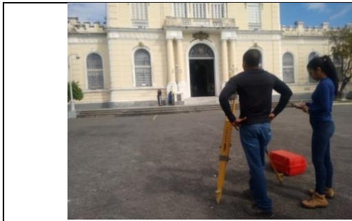
Figura 18b: Mira na Ré sobre a RN 3640L e a primeira estação de nivelamento. Foto: 16 de julho de 2018.
