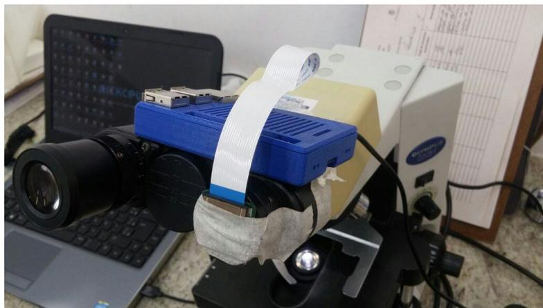
Figura 57 - Câmera acoplada ao microscópio.
