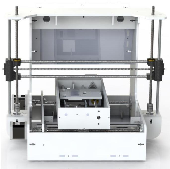
Figura 61 - Novo sistema mecânico montado com os eixos X, Y e Z.
