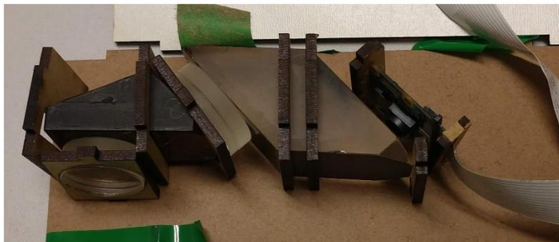
Figura 59 - Lentes e prismas extraídos do tubo óptico de um microscópio.
