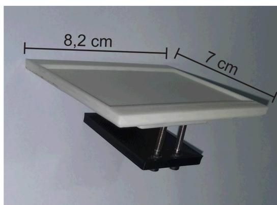
Figura 41 - Mesa para acomodação da lâmina.
