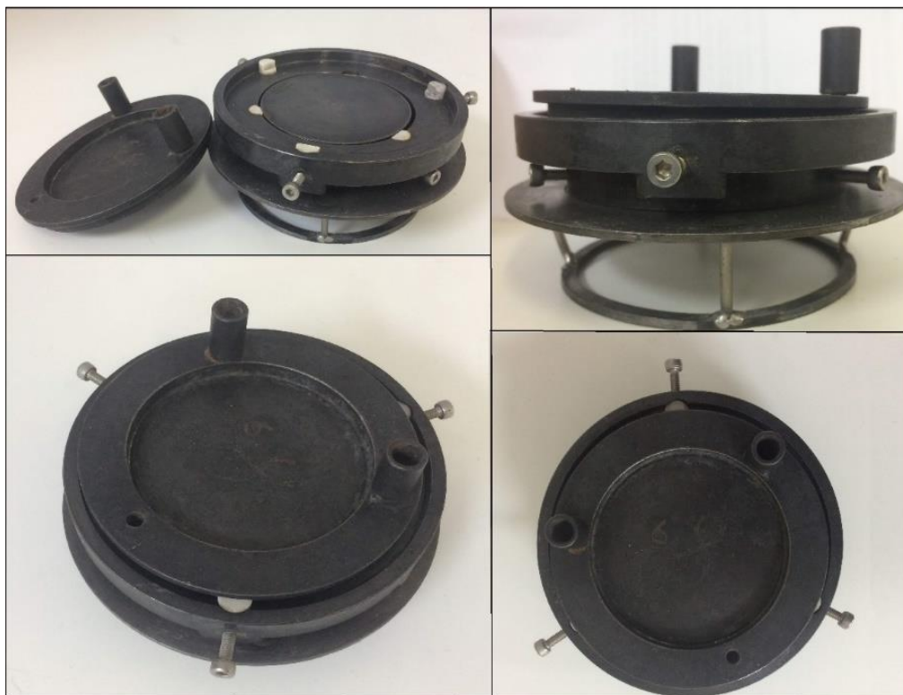
Figura 13 - Célula para medição de resistividade vista por vários ângulos.
