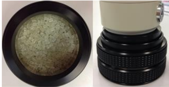
Figura 11 - Suporte de materiais granulados.
