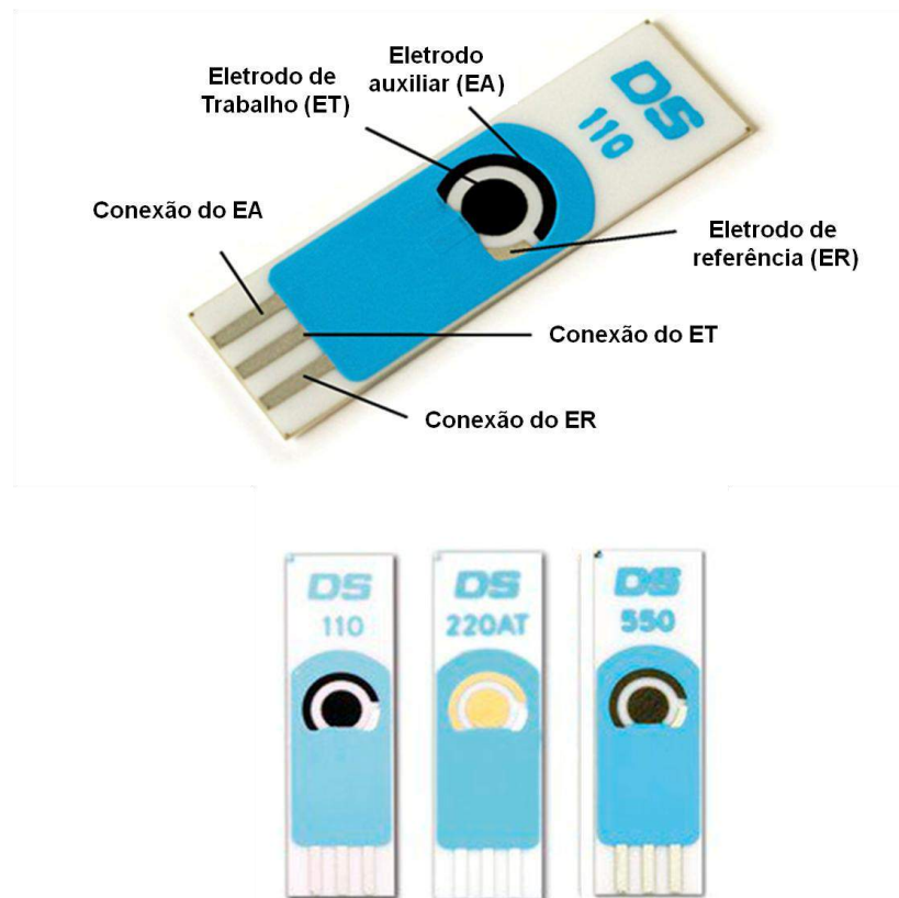
Figura 11. Esquema ilustrativo de um SPE de carbono contendo os três eletrodos (trabalho, referência e auxiliar), e abaixo SPEs de carbono, ouro e platina (da esquerda para direita).
