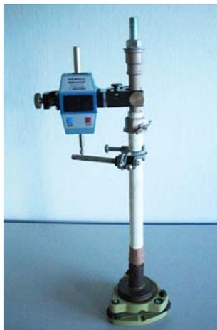
**Figura 5.3** – Dispositivo utilizado para o deslocamento da antena.
