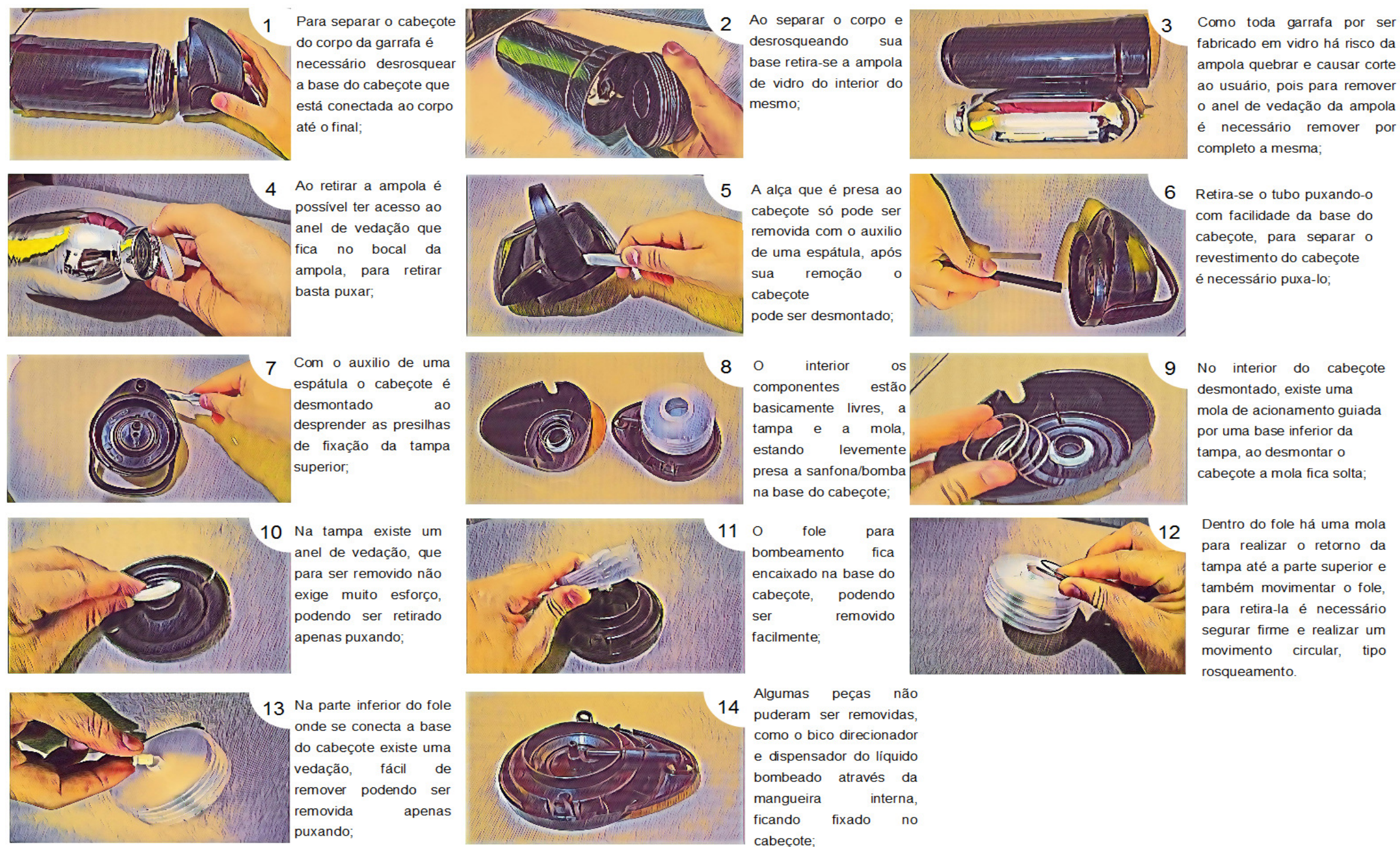
Figura 8 - Etapas de desmontagem.
