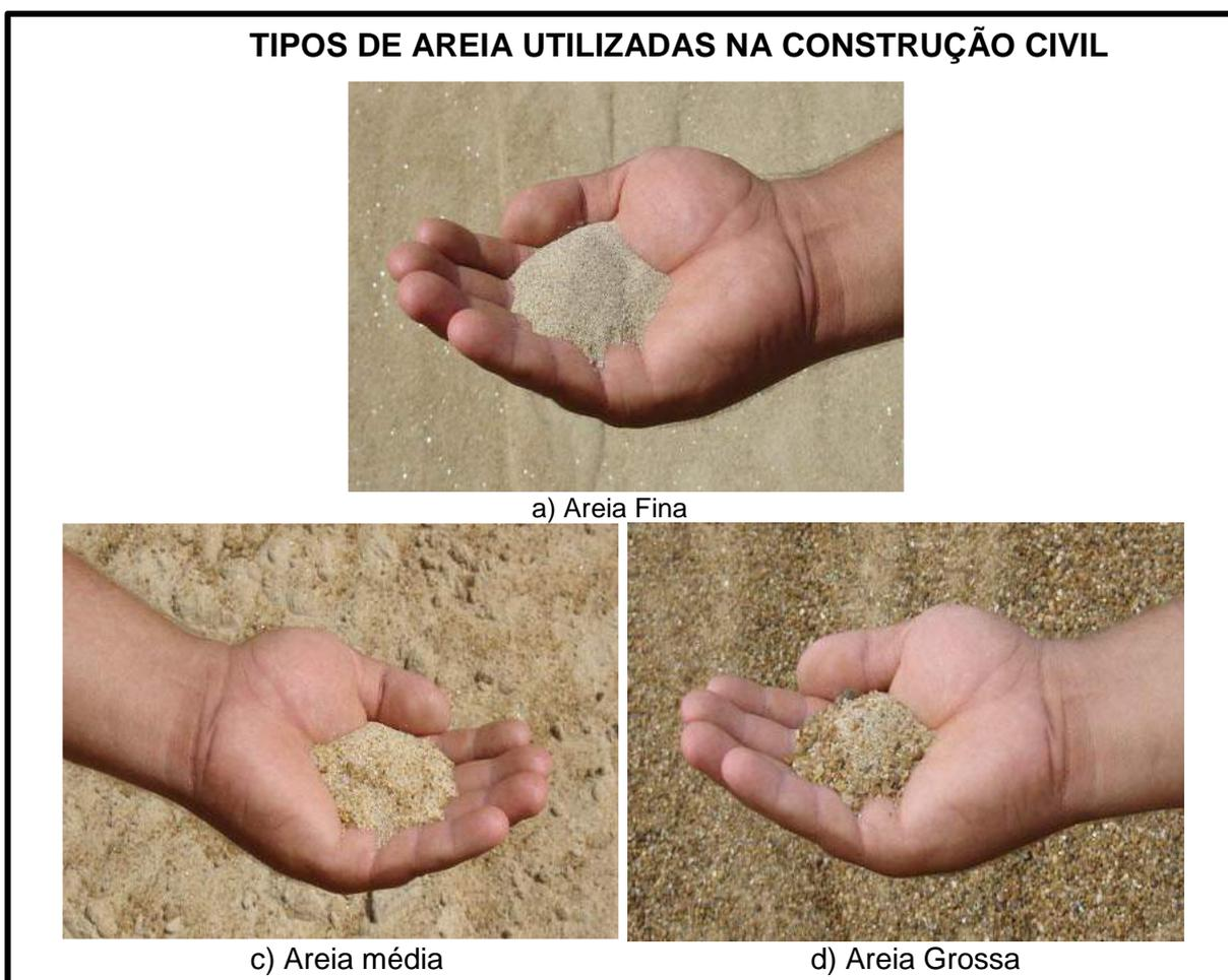
Figura 50 – Tipos de Areias Utilizadas na Construção Civil
