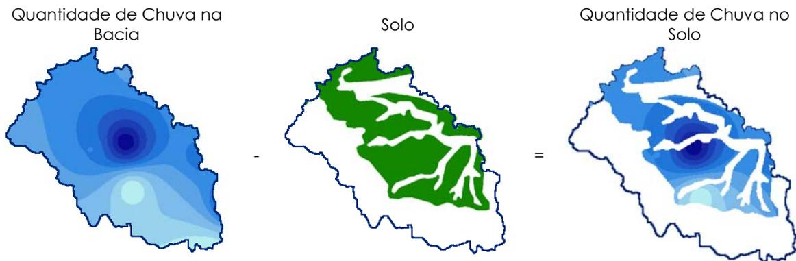
Figura 49 – Ilustração da Álgebra de Mapas para Determinação da Chuva para Solo Tipo 2
