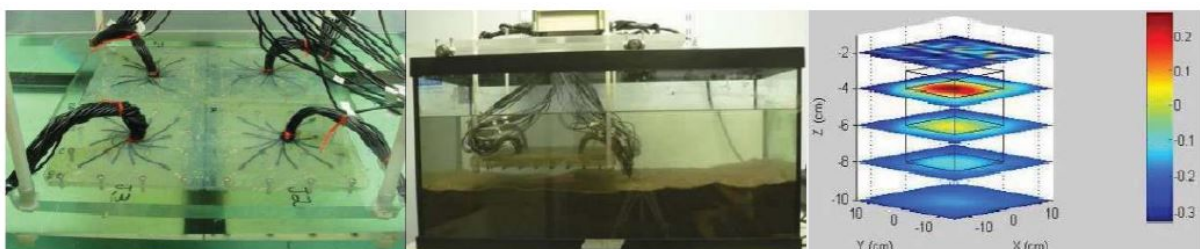
Figura 6 – Aplicação da TIE para detectar objetos enterrados em sedimentos
