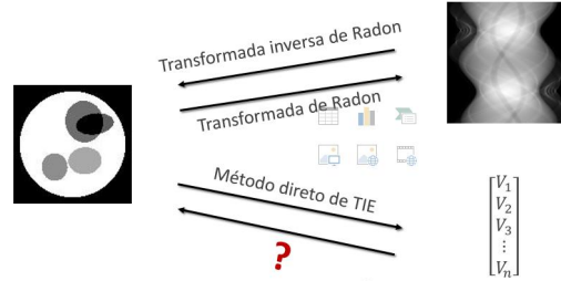
Figura 2. O método proposto visa a obtenção de imagens de TIE a partir de diferenças de potenciais elétricos medidas na superfície do domínio.
