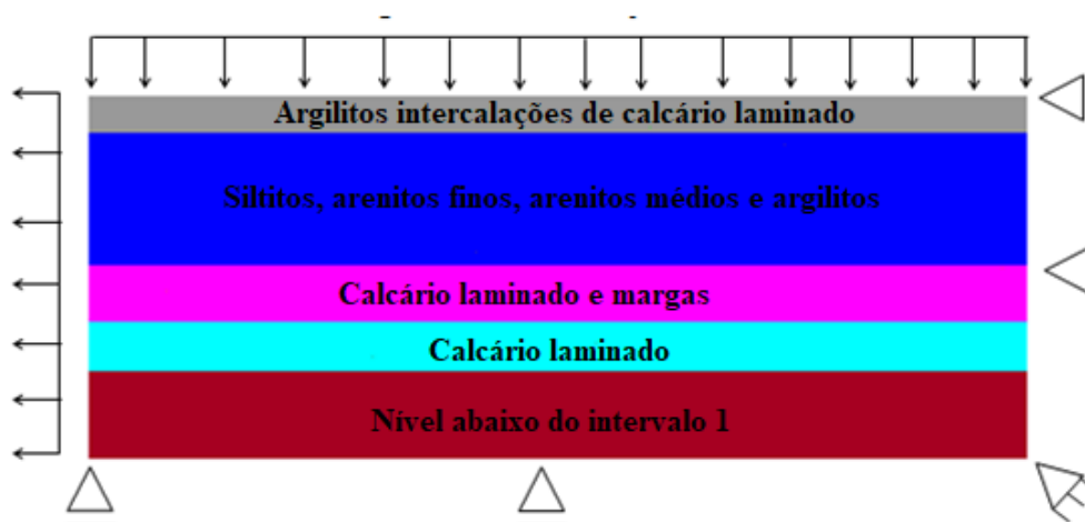
Figura 66 - Detalhamento do domínio e condições de contorno.
