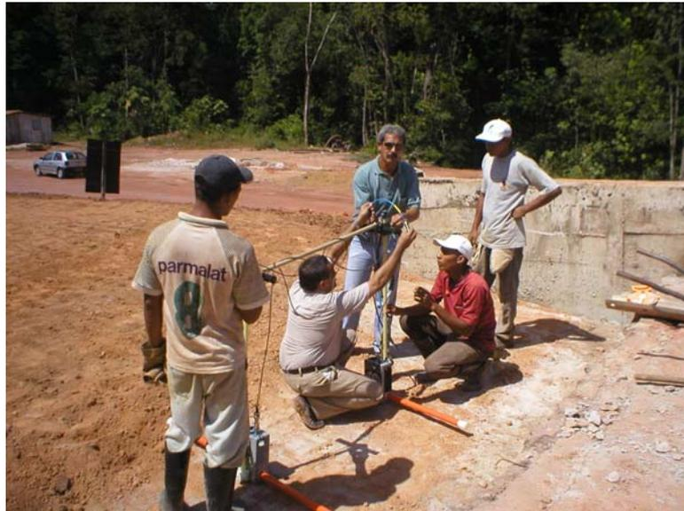
Figura 4.3. Arranjo mostrando o esquema CMP.
