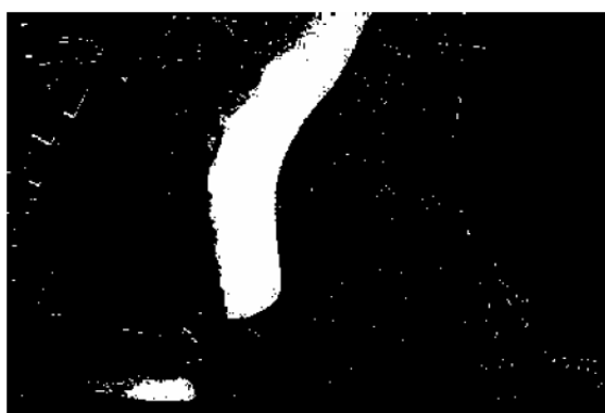
Figura 2 - Segmentação de corpos d'água através do algoritmo K-means usando a imagem IIA.
