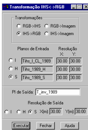
Figura 61 – Reversão de IHS para RGB, utilizando a componente I realçada.
