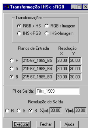
Figura 59 – Cálculo de IHS nas três bandas (5, 4 e 3) originais de 11/03/89.
