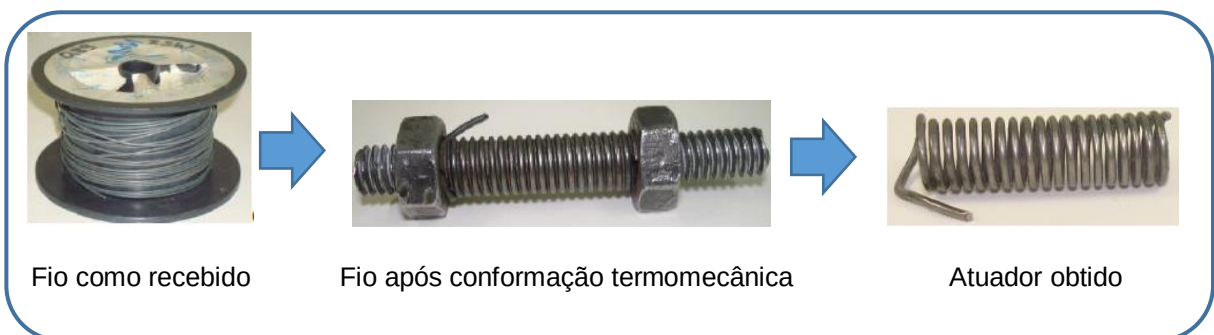
Figura 20- Etapas da preparação dos atuadores helicoidais.
