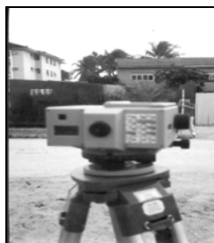
Figura 24: Nível eletrônico no campo primário
