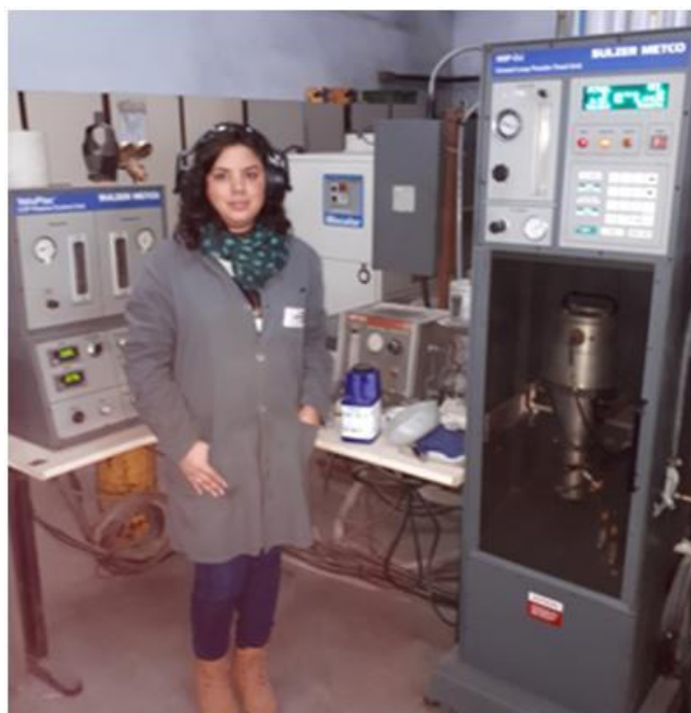
Figura 38 – Equipamento utilizado para a deposição por APS pertencente a Revesteel Metalização marca Sulzer Metco modelo 9MB Plasma Spray Gun.
