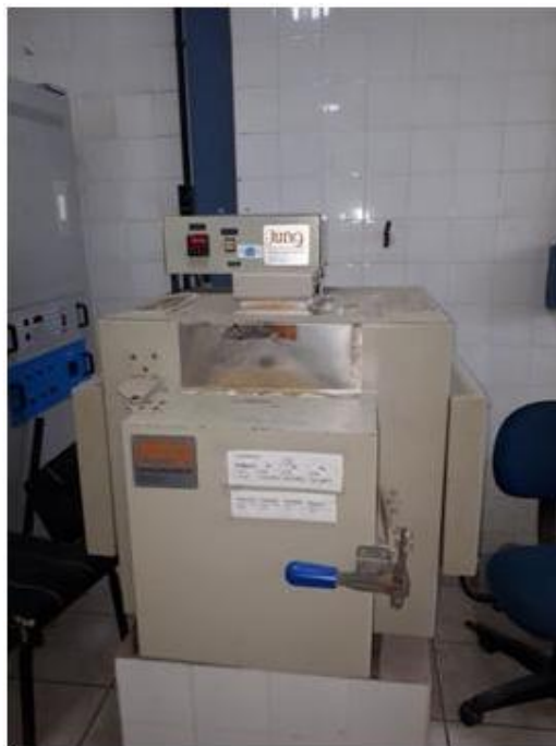
Figura 26 – Forno tipo mufla, Modelo Jung 0614, temperatura máxima de 1400 °C.
