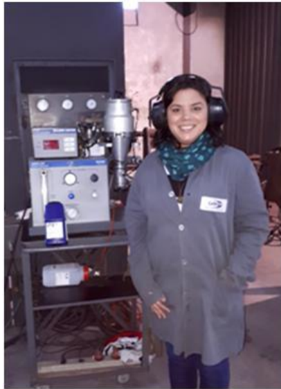
Figura 37 – Equipamento utilizado para a deposição por HVOF pertencente à Revesteel Metalização. – (a) Sulzer Metco modelo Diamond Jet Gun. (b) Tipo de Pistola Usada – DJ Gun.
