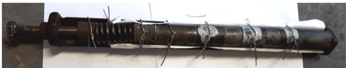
Figura 47 – Amostras acomodadas no dispositivo de colagem durante o tempo de cura do adesivo.
