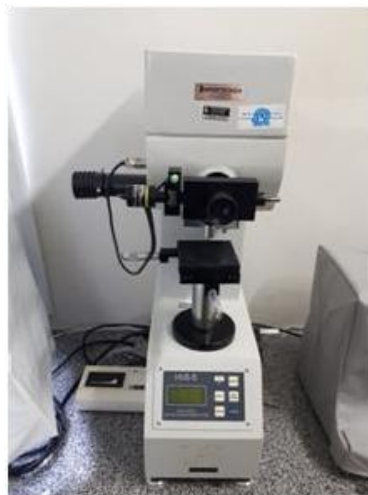
Figura 30- Microdurômetro acoplado a um microscópio metalográfico Zeiss, modelo Jenavert com penetrador modelo HVS-5 nº 0021.
