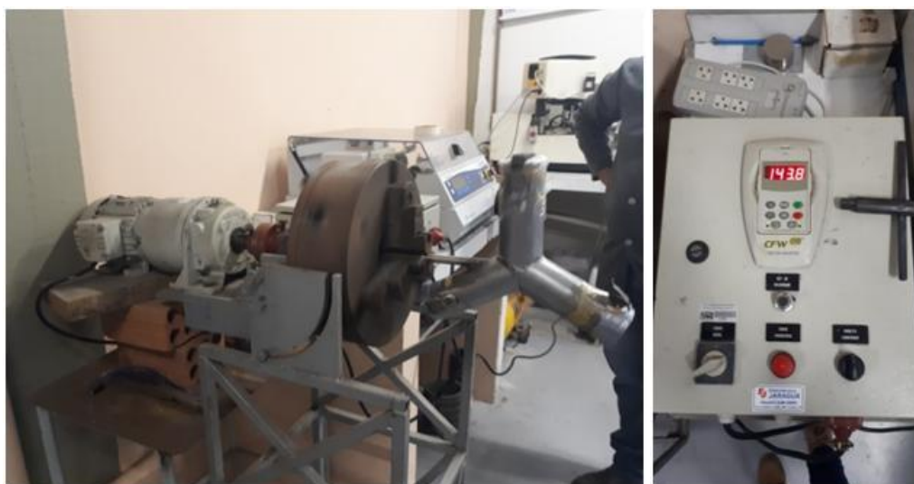
Figura 31 – Misturador em Y usado para homogeneizar o compósito Z8Y – 10T.
