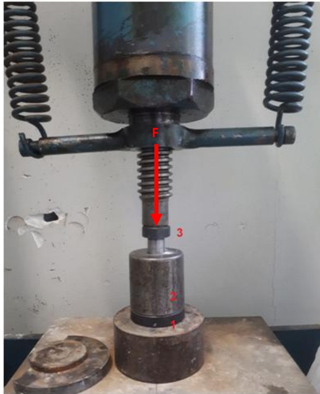
Figura 23 – Prensagem uniaxial, mostrando a aplicação de esforço de compressão na matriz metálica.
