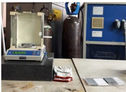
Figura 51 – Pesagem dos corpos de provas em balança analítica antes e após ensaio de riscamento.
