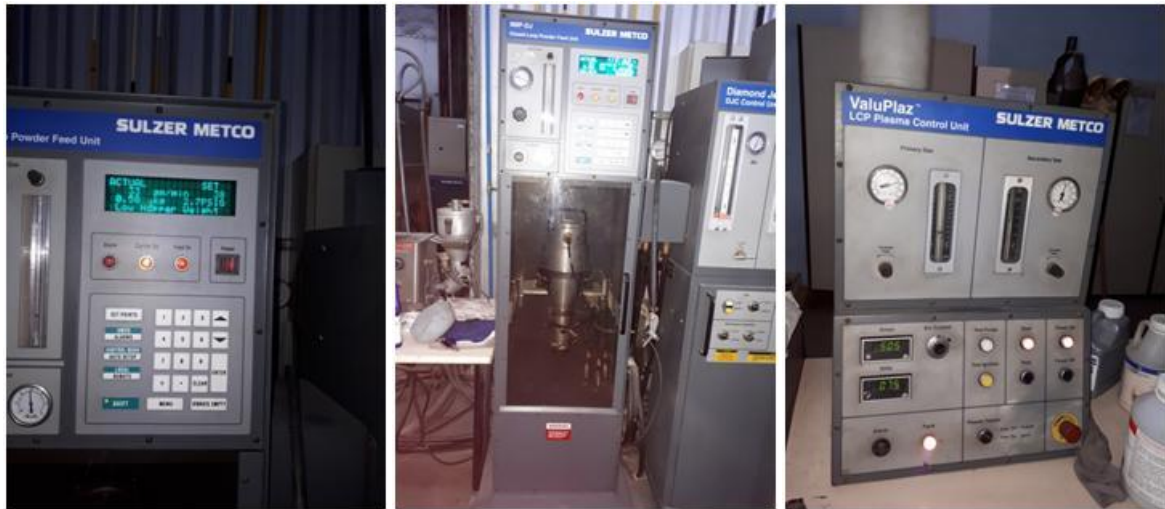
Figura 41 – Equipamentos usados para a deposição por APS da camada Top Coat – Z8Y – 10T.
