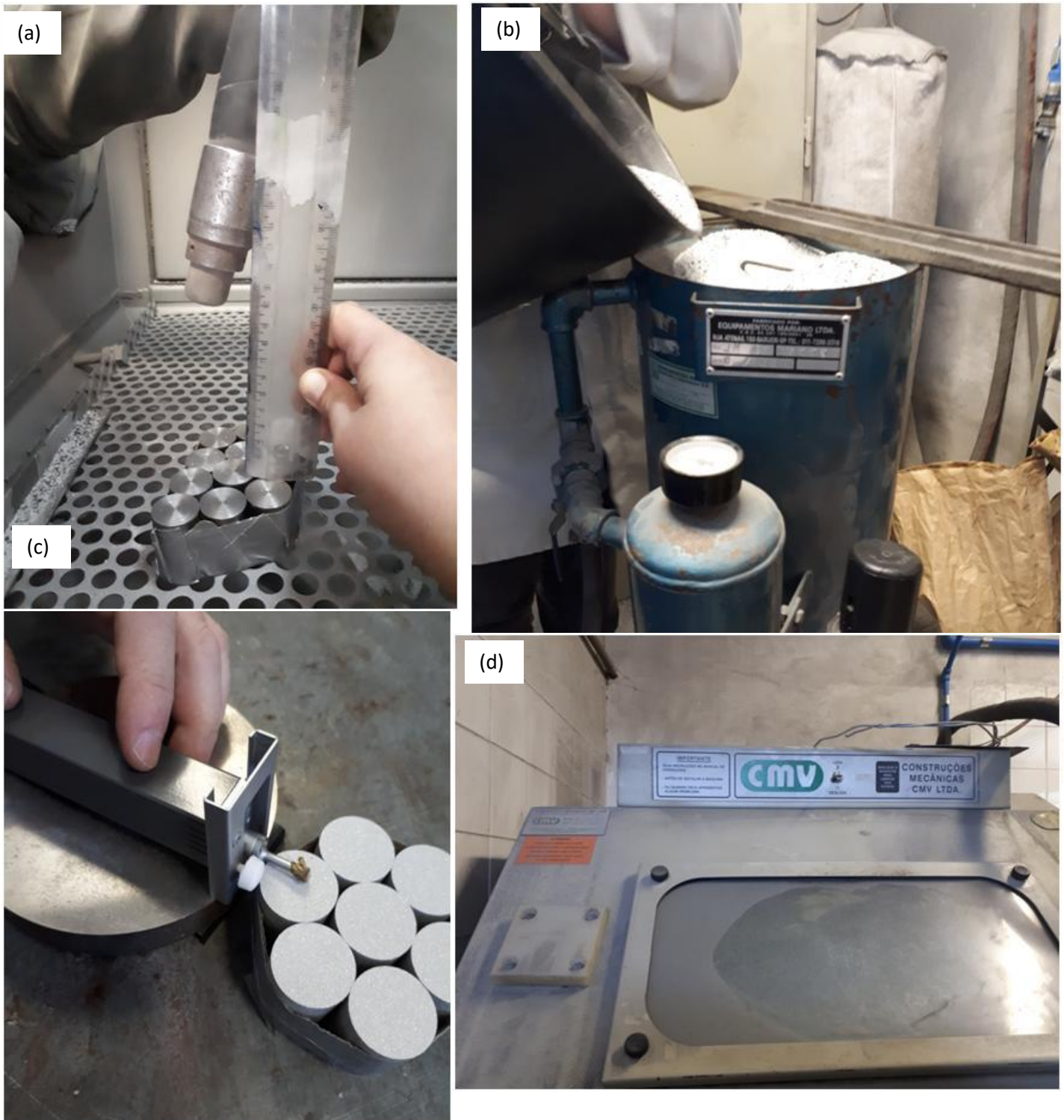
Figura 34 – Processo de Jateamento, realizado no LABATS – UFPR. (a) Distância de 100 mm do jato ao corpo de prova, (b) Alimentação do abrasivo óxido de alumínio, (c) Medição da rugosidade após jateamento e (d) Máquina jateadora usada.
