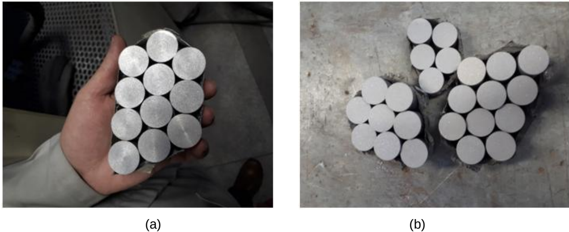
Figura 35 – Corpos de provas (a) Antes e (b) Depois de jateados.
