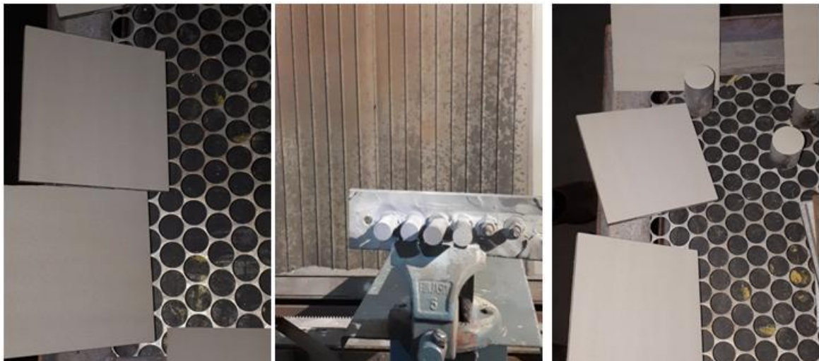
Figura 40 – Corpos de Prova aspergidos com a camada Bond Coat NiCrAlY através do processo HVOF.
