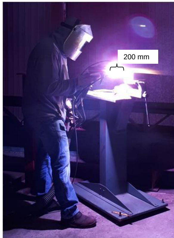
Figura 39 – Aspersão sendo feita nos Corpos de Prova - Distância de 200 mm para aspersão no processo HVOF – Revesteel Metalização.
