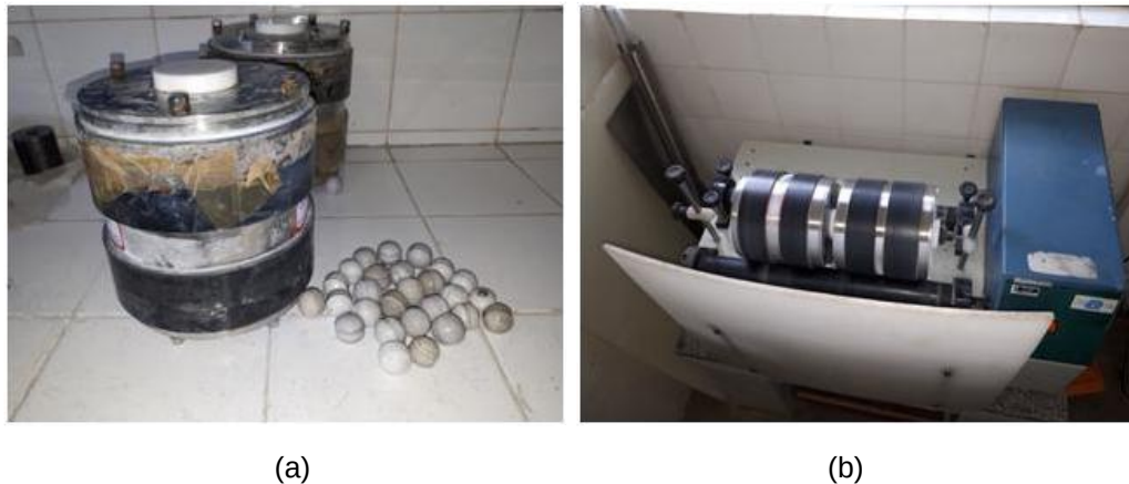
Figura 21 - Moagem. (a) Jarra de aço inoxidável do moinho de bola, com bolas de alumina, (b) Moinho de bola.
