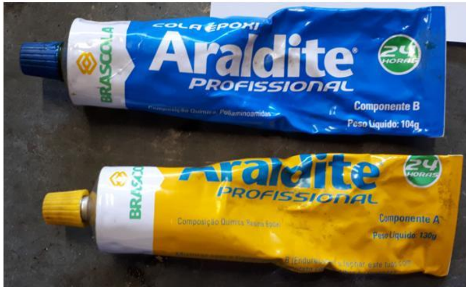
Figura 45 – Adesivo usado para o ensaio de aderência – Brascola Araldite Profissional 24h.
