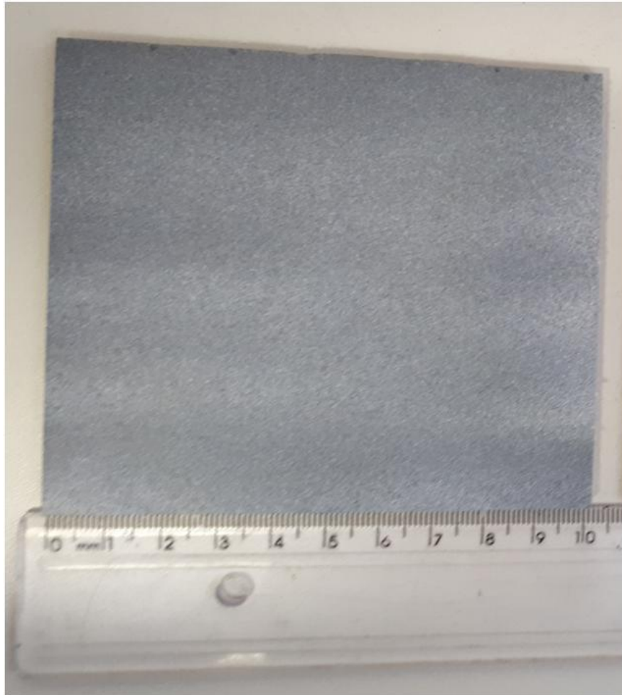
Figura 32 – Chapa de aço ASTM A 576, dimensão 100x100x5 mm usado como substrato para aspersão térmica.
