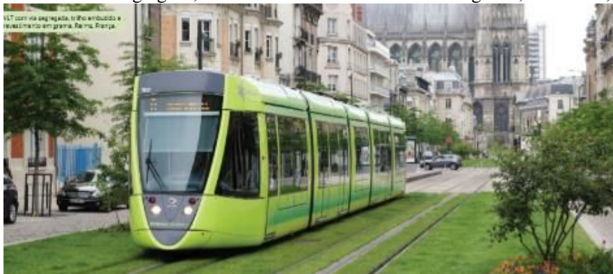
Figura 34- VLT via segregada, trilho embutido e revestimento em grama, em Reims, França
