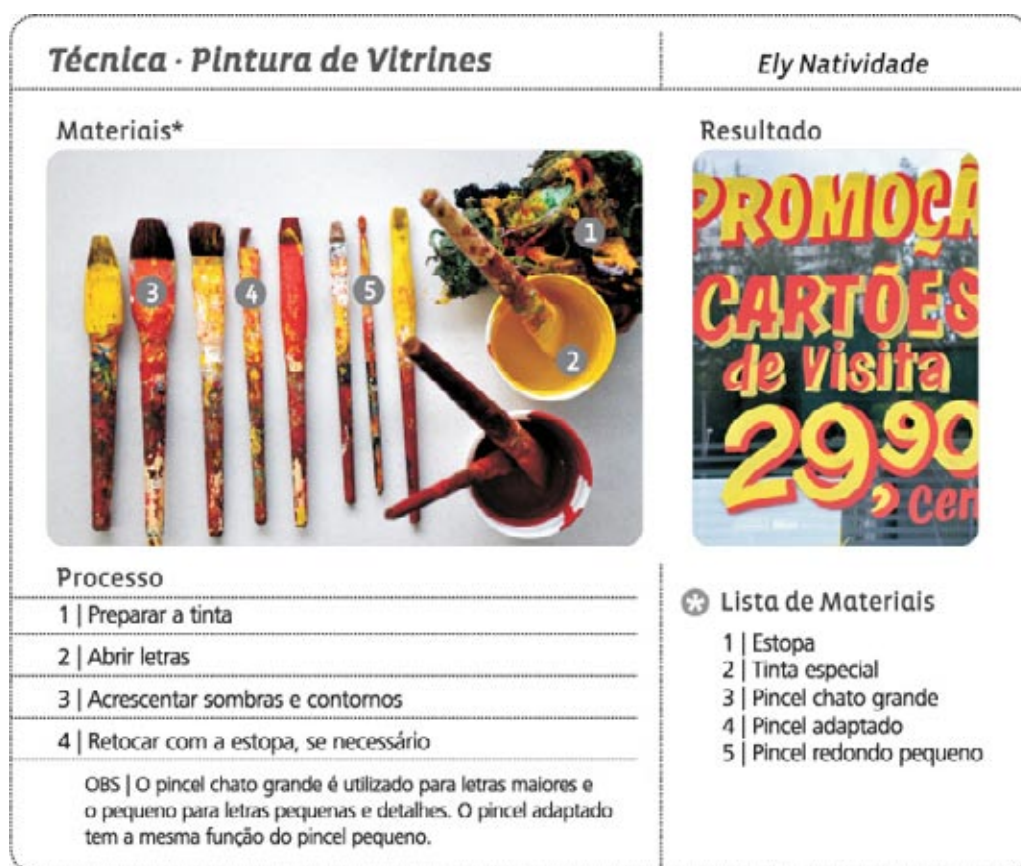
Figura 104. Guia para pintura de vitrines. (Fotos: Damião Santana).
