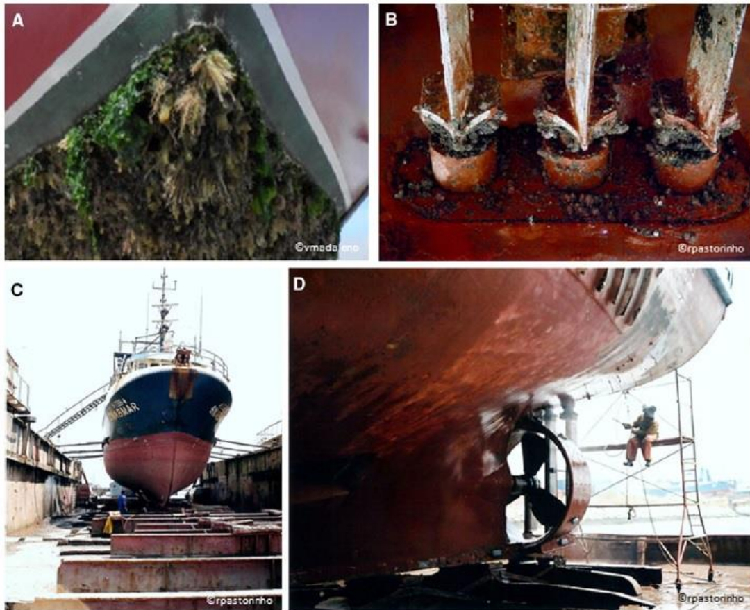
FIGURA 3. Processo de incrustação e aplicação de tinta anti-incrustante.
