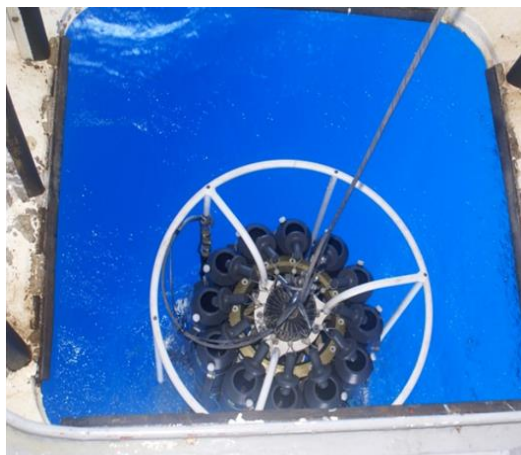
Figura 4 - CTD acoplado com conjunto de garrafas Niskin para obtenção de dados.
