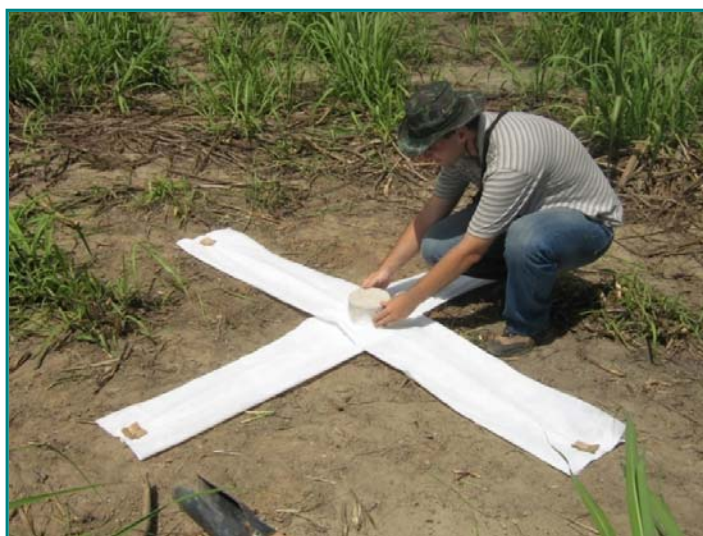
Figura 50 – Pré-sinalização dos Marcos.
