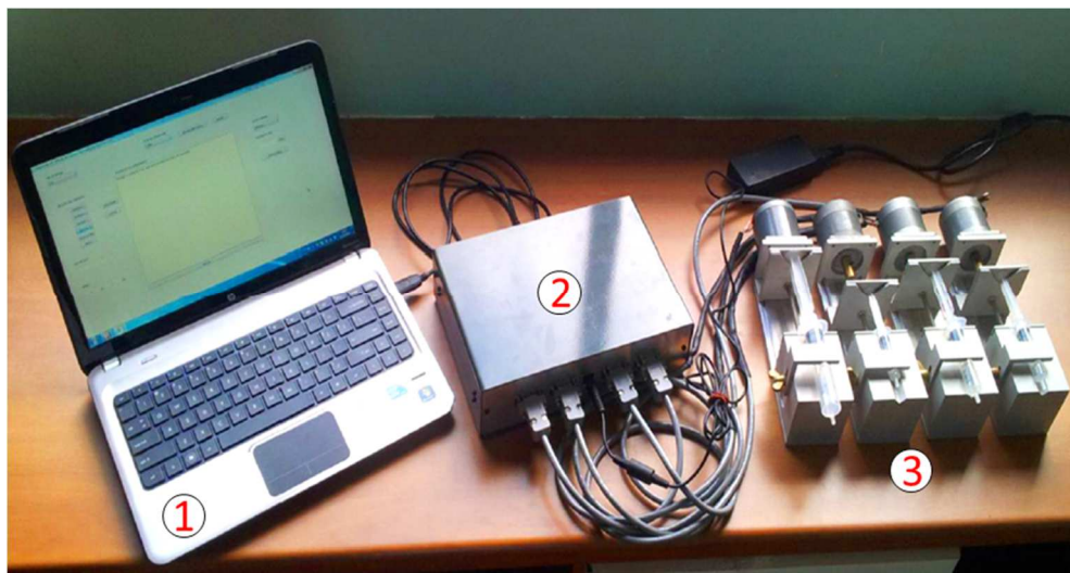
Figura 20 - Foto ilustrativa do sistema de infusão. 1. Notebook com interface gráfica criada em Qt Creator , 2. Módulo de potência controlado pelo Arduino Mega e 3. Peças motorizadas com suporte para as seringas.
