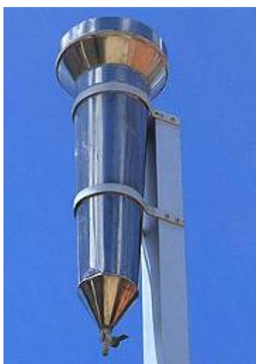
**Figura 3 - Pluviômetro, instrumento que mede a lâmina de água precipitada. Fonte: <http://gegep.com/> (último acesso 23/04/2008).**
