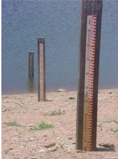
**Figura 4 - Lance de réguas linimétricas. Fonte: <http://www.hidrosed.ufc.br>**
