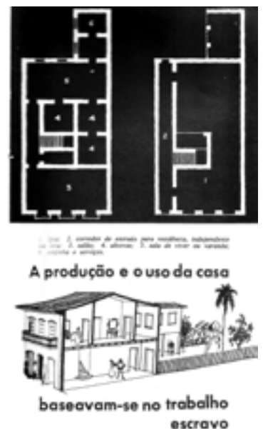
Figura 09 – Planimetria e secção do Tipo colonial Sobrado.
