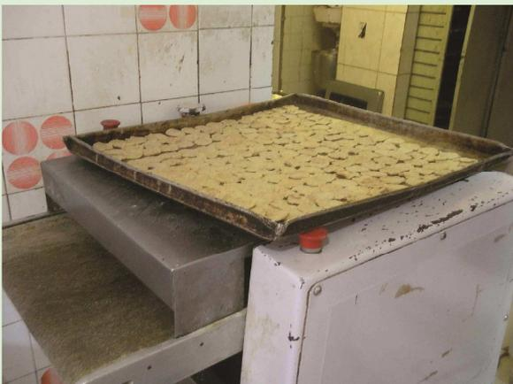
Observa-se, nas fotos ao lado, o desgaste pelo tempo de uso dos equipamentos do setor de produção. Alguns problemas podem ser relatados a partir daí, tais como: defasagem do maquinário, interferindo na velocidade de produção; limitações tecnológicas para ampliar, com eficiência e eficácia o mix dos produtos da empresa; pontos de ferrugem nos maquinários, podendo interferir na qualidade do produto final; além da disposição inadequada desses equipamentos pela falta de espaço do próprio ambiente.
