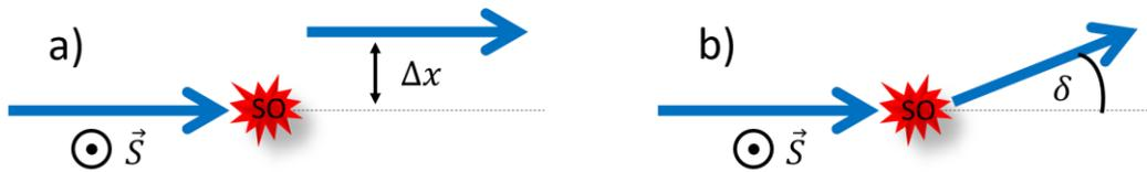
Figura 3-10: Ilustração dos mecanismos skew scattering a) e side jump b).
