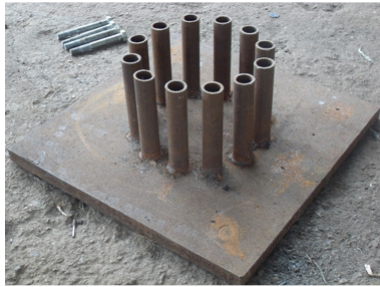
(A) – Base para sustentação do poste
