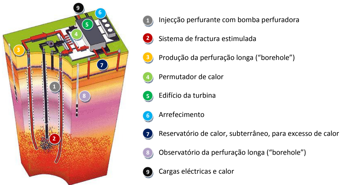
Figura 09: Princípio de uso da energia térmica
