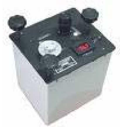
Figura 2.8 – Gravímetro LaCoste & Römberg modelo G – Precisão: 0,01 mgal
