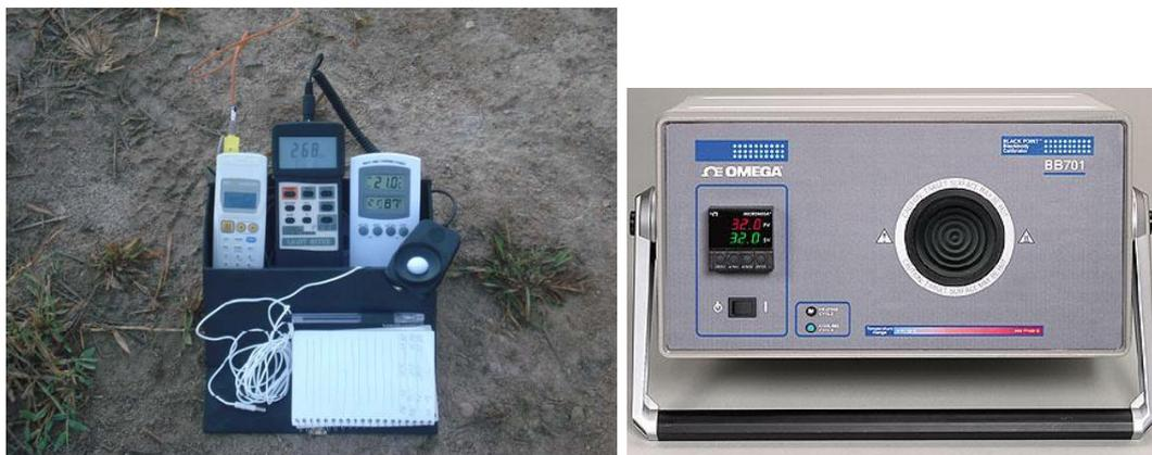
Figura 5.4 (a) Instrumentos auxiliar de campo da esquerda para a direita: Logger HH84, Luxímetro – Fabricante Instrutherm – Modelo LDR-208,
