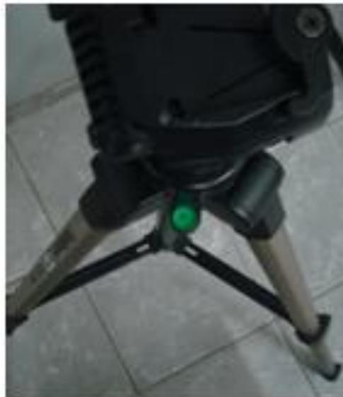
Figura 2.2 Nível do tripé, suporte utilizado para nivelar o instrumento.
