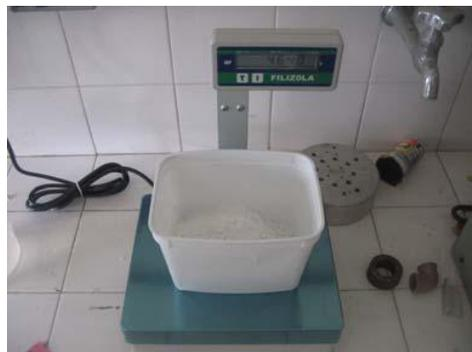
Figura 4.1 Medição do pó de gesso em balança digital
