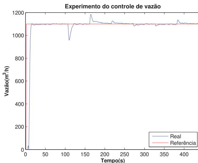
Figura 61 – Avaliação da robustez do controlador( vazão desejada em 1100 \text{ m}^3/\text{h} ).
