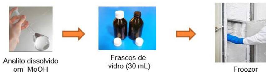
**Figura 9.** Fluxograma do preparo das soluções estoque a 100  $\text{mg L}^{-1}$
