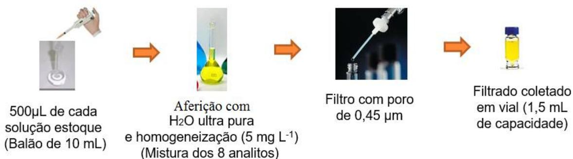
**Figura 11.** Fluxograma do preparo da solução à 5,0 mg L<sup>-1</sup> com os oito analitos
