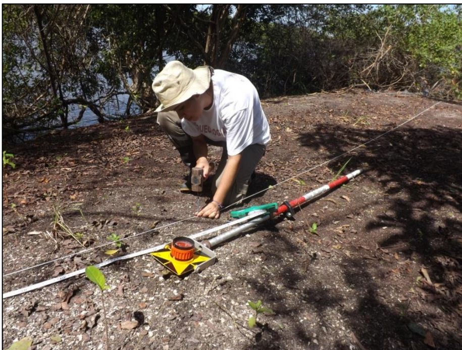
Figura 19: Materialização dos vértices das quadrículas de 4m 2 .
