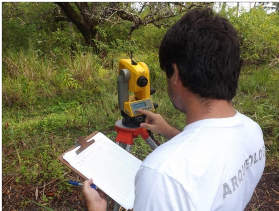
Figura 17: Configuração da Estação Total para coleta de dados da poligonal topográfica.
