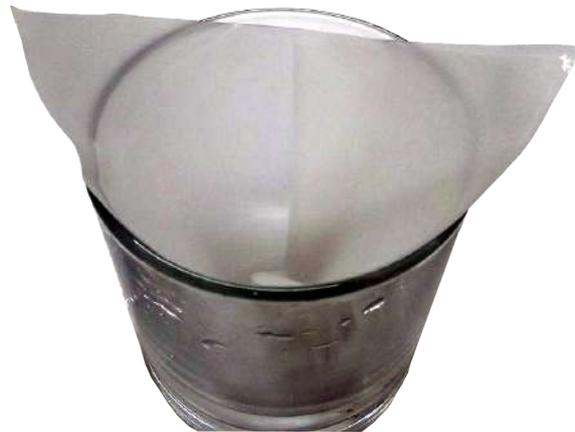
**Figura 37:** Recipiente utilizado nos ensaios de deterrência. Fonte: Foto de Júlio Aguiar.
