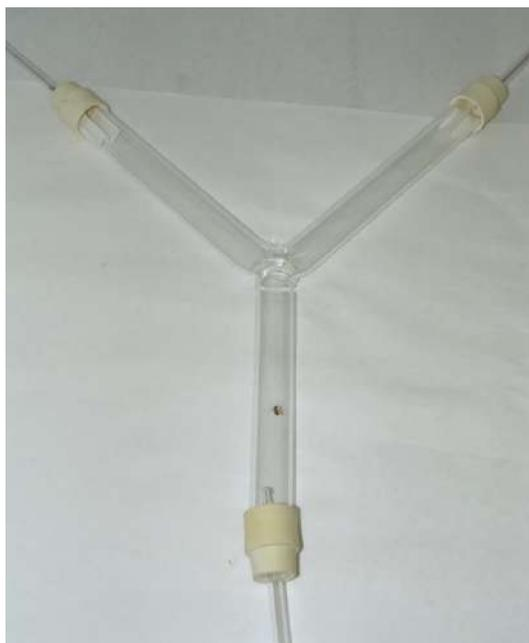
**Figura 11:** Aparato para os ensaios de dupla escolha (olfatômetro em "Y"). Fonte: Os autores do presente trabalho.
