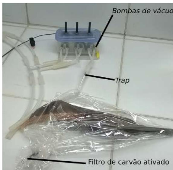
**Figura 9:** Montagem para extração de voláteis por headspace (sem o branco). Fonte: Os autores do presente trabalho.
