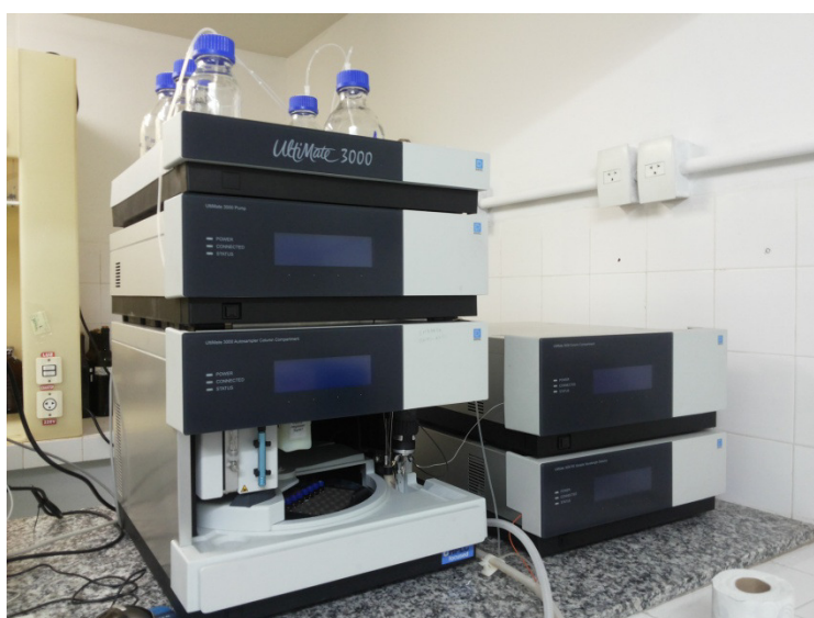
Figura 11. Cromatógrafo Ultimate 3000 Dionex®, com degasificador, bomba quartenária, forno e detector UV/Vis.
